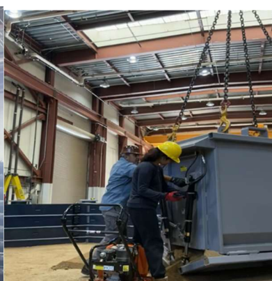
Figure 19: Using hopper to pour soil
