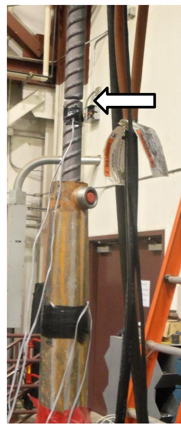
(d) Bar failure
